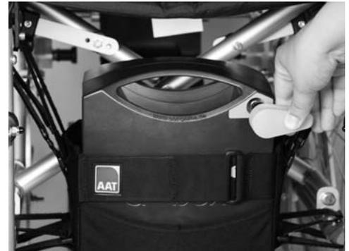
Ora inserire il connettore del cavo di alimentazione nella presa d'uscita di movilino.
